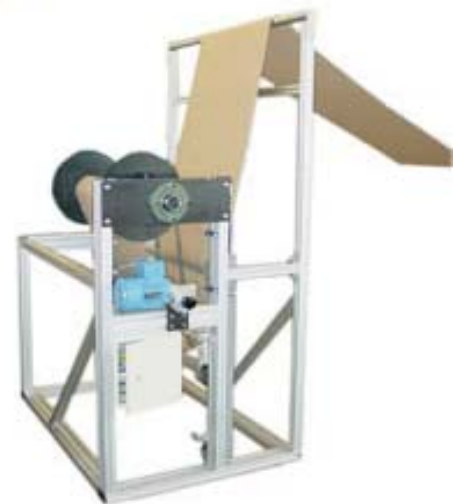
Gesteuertes Aufwickeln von Papier (Coil-Zwischenlage) mit Bruchüberwachung, Signalweitergabe an Not-Aus Kreis der Stanz- / Umformpresse.
