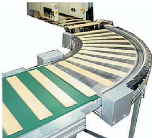
Synchronisierte Werkstückübergabe in einer Parkettfertigung.
