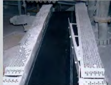
ContiClean® A-H im Einsatz zur Förderung von Titandioxid
